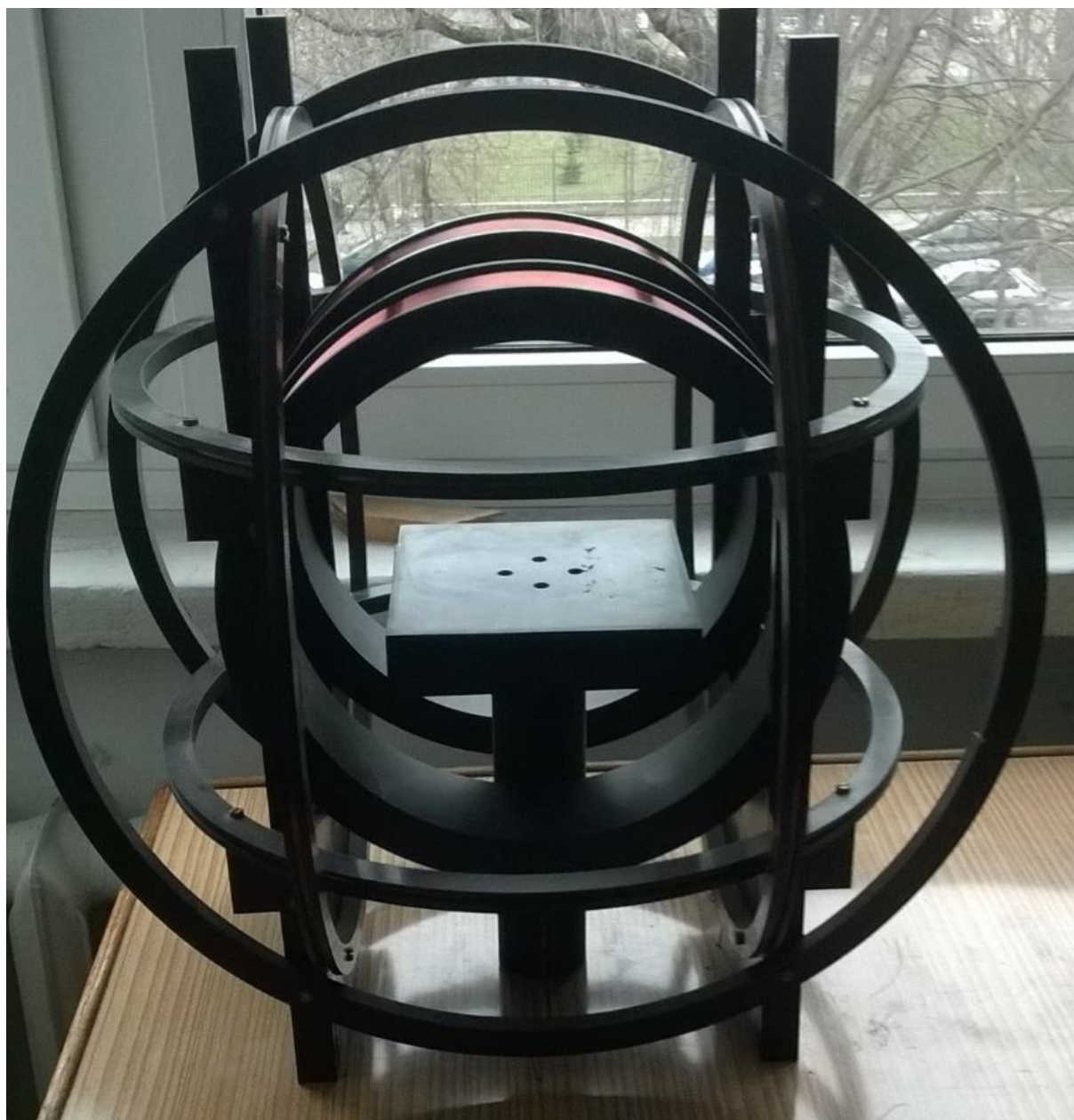
Rys. 5.3. Cewki Helmholtza do wzorcowania czujników pola magnetycznego. Oś główna zadaje pole mierzone przez magnetometr, osie dodatkowe służą do kompensacji pola ziemskiego
